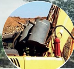
TANQUE DE ÁGUA
